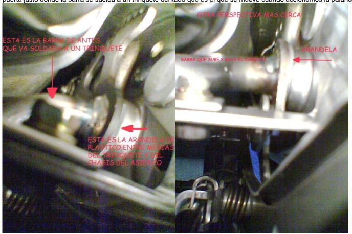
Si no os quereis complicar mucho la vida os dire que yo como arandela he usado esas que vienen en las tarrinas de los cd's que suelen ser transparentes para que los cd's no rozen con el fondo. Para introducirla solo hay que hacer un poco de palanca con un destornilador para separar el eje de giro de la barra del chasis del asiento y con un poquito de maña meterlo y por supuesto cortar la arandela por un lado porque sino no os entrara je,je
