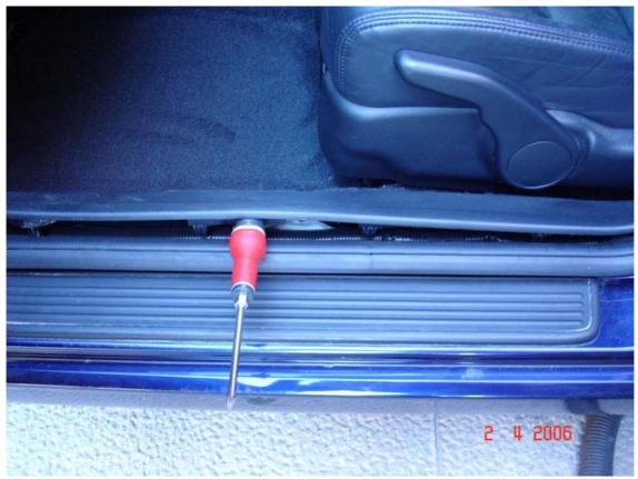
Cuando se levante cuidadín que los clips metálicos seguramente se quedaran puestos y saldrá solo el plástico
