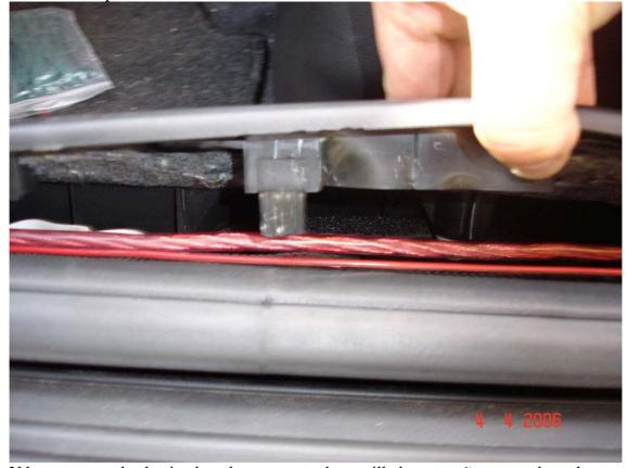
Y hay que sacarlos haciendo palanca con un destornillador pequeño y ponerlo en las pestañas de plástico, que si no después no podremos montarlo ya que los plásticos se
