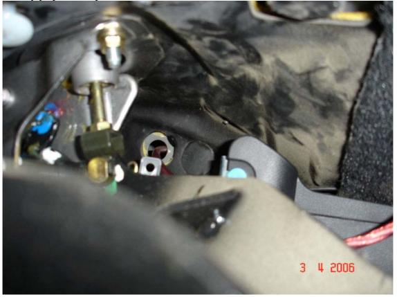
Yo he tapado el agujero de paso del cable con silicona para que no entre agua ni polvo y ahora ya podemos montar el plástico del capo y el del paso de rueda simplemente dándole de nuevo su forma, colocando los soportes en sus respectivos orificios y apretando la parte central para que queden fijos.
