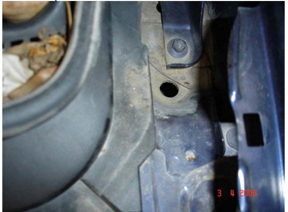
Bien ahora tenemos que desmontar un poco el paso de ruedas, con un destornillador fino tendremos bastante, si suponemos la rueda una esfera de reloj con sacar los dos soportes que hay a la 1 y las 2 más o menos hay bastante.
